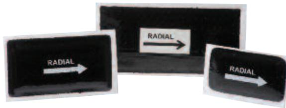
Эти цельноформованные детали для ремонта радиальных легковых шин имеют цельную конструкцию и тонкие, скошенные края. Они армированы кордом на всем протяжении, придавая прочность изделию, в то же время позволяя ему оставаться гибким. Эти детали предназначены для химической вулканизации.
