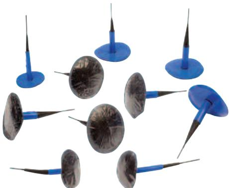
Грибки не требуют специальных приспособлений для установки. Вставьте проволоку в повреждение изнутри шины и вытащите с другой стороны шины. Ножка и шляпка грибка покрыты вулканизационным слоем для обеспечения надежной вулканизации как внутри повреждения так и с внутренней поверхностью шины. Грибки вулканизируются химическим или горячим методом. Грибки № 13-673 и 13-674 черного цвета с серым вулканизационным слоем. Ножка и весь грибок защищены синей полимерной оболочкой.
