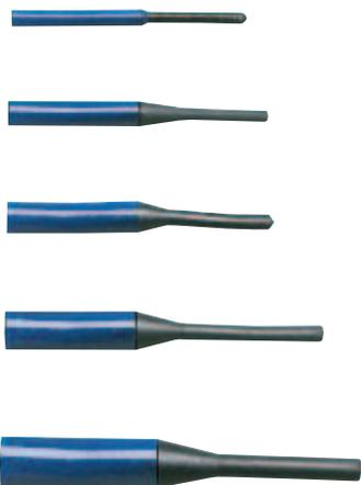
Новейшим дополнением к разнообразным вставкам, представляемым X-tra Seal являются протяжные вставки. Они предназначены для заполнения повреждений в шинах радиального типа или в шинах с диагональным кордом пассажирского и грузового транспорта. Протяжные вставки имеют высококачественный синий вулканизационный слой и вулканизируются химическим методом или в горячих вулканизационных системах. Для легкости установки вставок используйте специальное проволочное приспособление.
