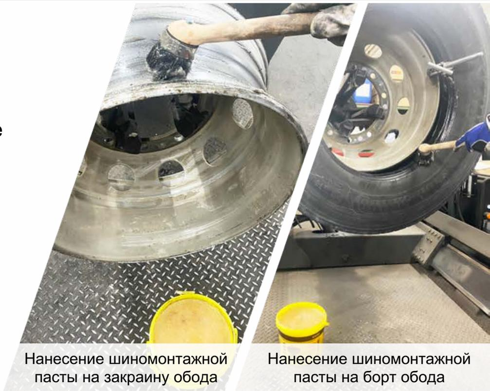
Нанесение шиномонтажной пасты на закраину обода
