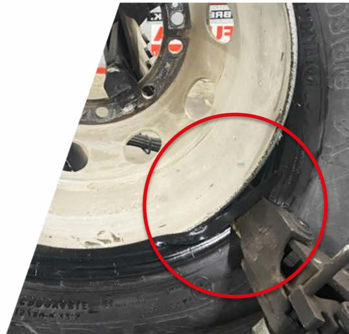
Трещина в зоне борта шины грузового автомобиля из-за избыточных усилий во время монтажа без монтажной пасты
