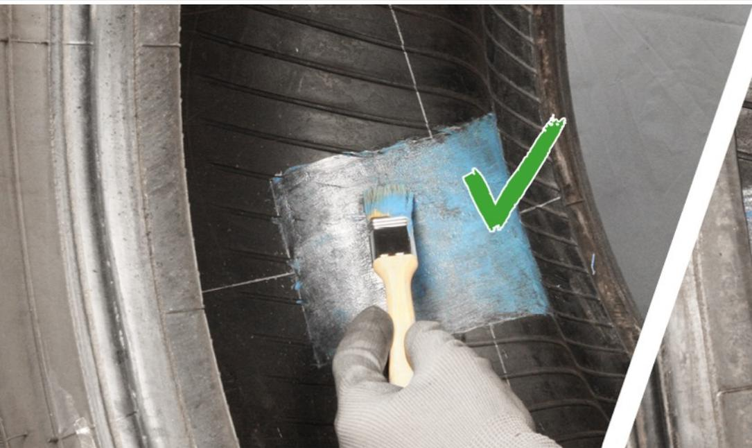
Клеевой слой клея Cement в шине грузового автомобиля, равномерное нанесение кистью с короткой щетиной
