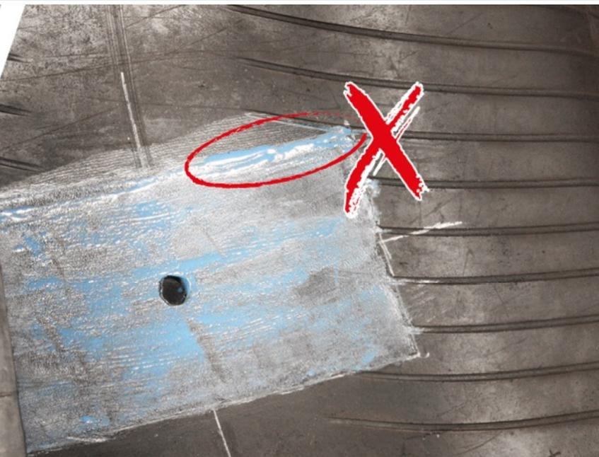
Нанесение клея Cement. Пример: неравномерное покрытие
