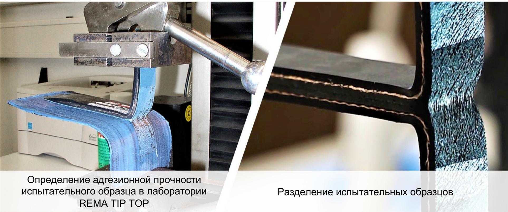
Определение адгезионной прочности
