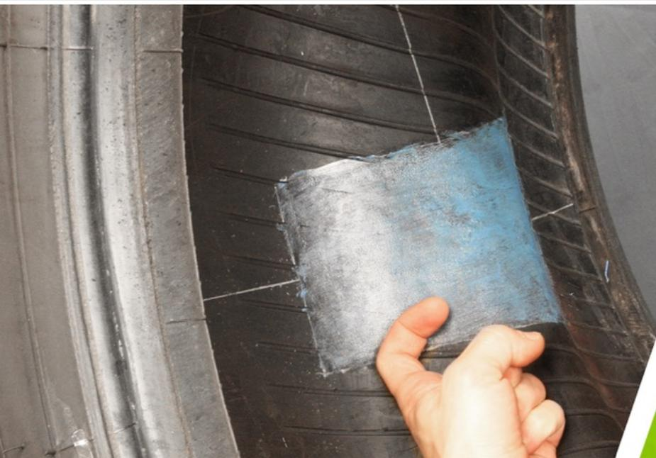
Самый лучший способ проверки клеевого слоя на степень высыхания – «проверка тыльной стороной пальца»
